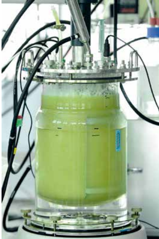
Ein Bioreaktor zur Methanproduktion im Labormassstab. (Bild: Electrochaea GmbH)
