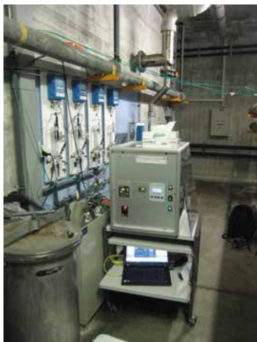
Apparatur für die kontinuierliche Trichloramin-Messung an verschiedenen Stellen des Badewasserkreislaufs. (Foto: Fabian Soltermann)
