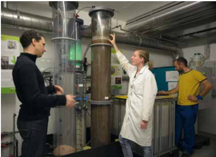
Abb. 1 n der Pilotanlage an der Eawag in Dübendorf wird der Urin der Mitarbeitenden zu Dünger aufbereitet. Foto: Peter Penicka
