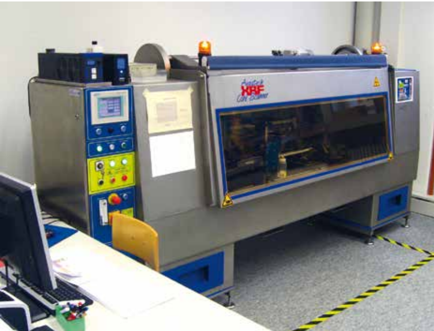
Abb. 2. Röntgenfluoreszenz- Kernscanner (XRF core scanner) von Avaatech am Geologischen Institut der ETH Zürich.
