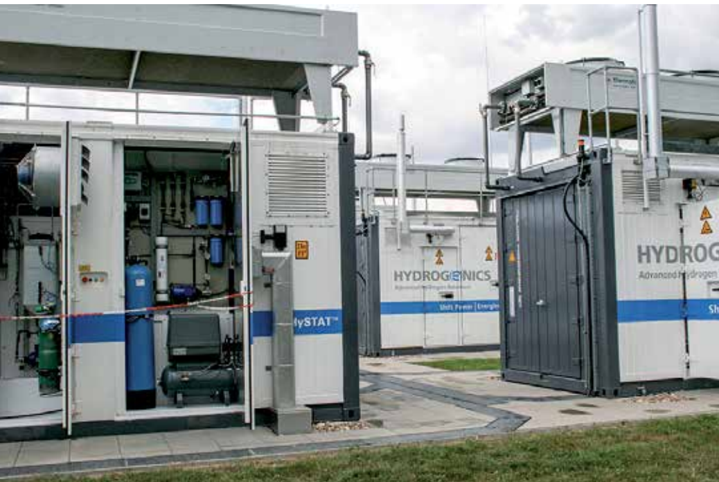
Alle Anlagen zur Wasserstoff-Erzeugung sind in Containern untergebracht.
