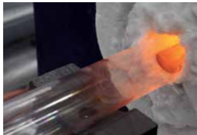
In einem horizontalen Rohrreaktor wird Kohlenstoff aus der Verbindung mit einem anderen Element gelöst (carbide-derived carbon, CDC).
